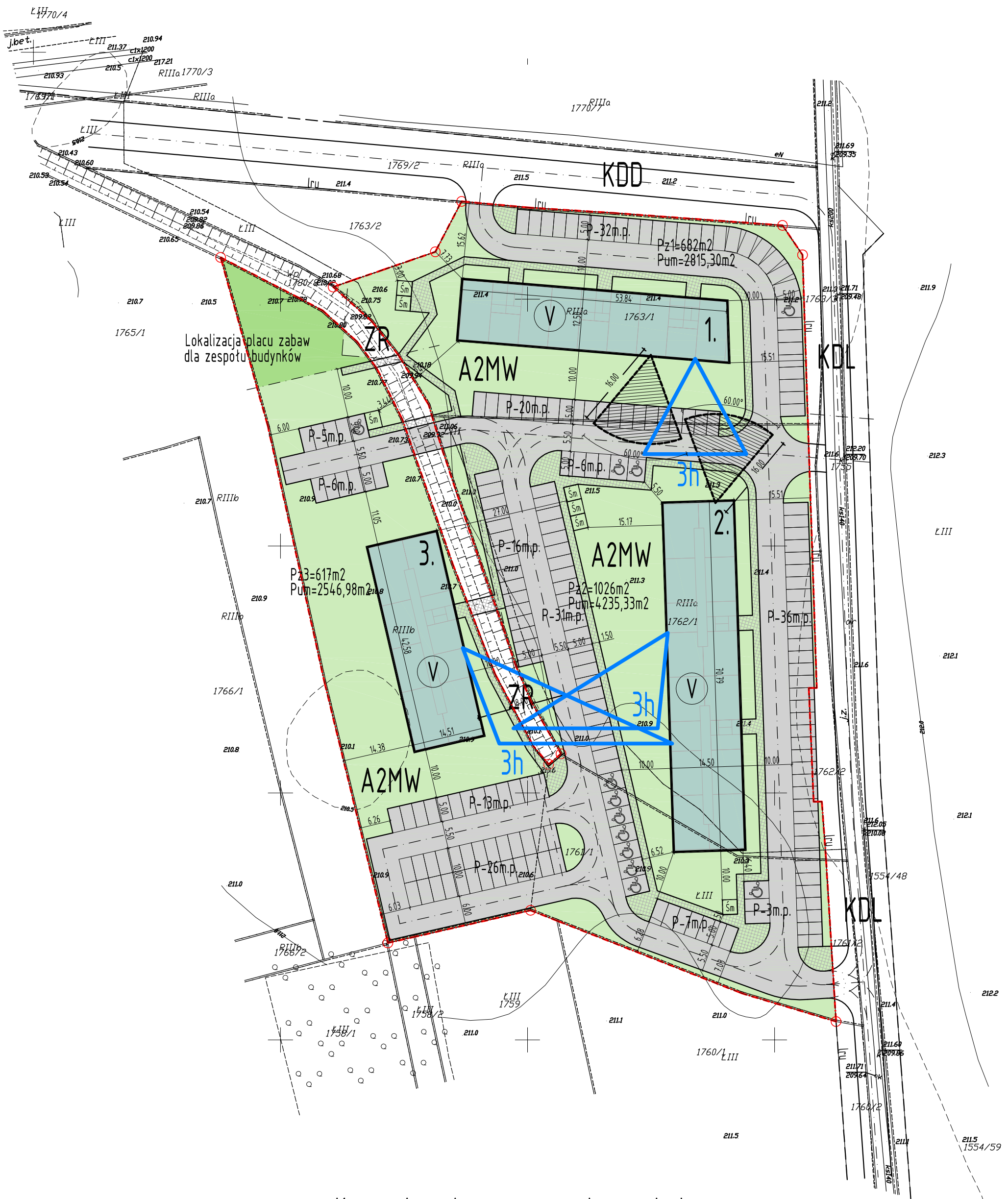
Koncepcja wstępna zagospodarowania terenu Zespół zabudowy mieszkaniowej wielorodzinnej Zdrój, ul. Parkowa 5, dz. nr ewid. 1234/5, 4321/1, 987/6
