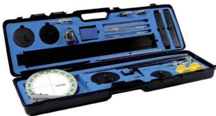
Zestaw do badania rozszerzalności cieplnej ciał - dylatometr
